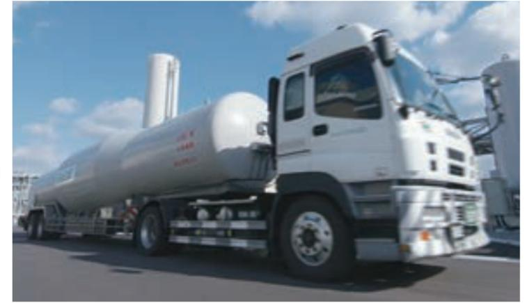
都市ガスの導管網が敷設されていない地域で天然ガスを利用する方法がLNGサテライト供給です。LNGは-162℃と超低温のため専用ローリー車を使用。東部ガス秋田LNG基地で専用ローリー車に充填され、お客さまのLNGサテライト基地まで輸送されます。
